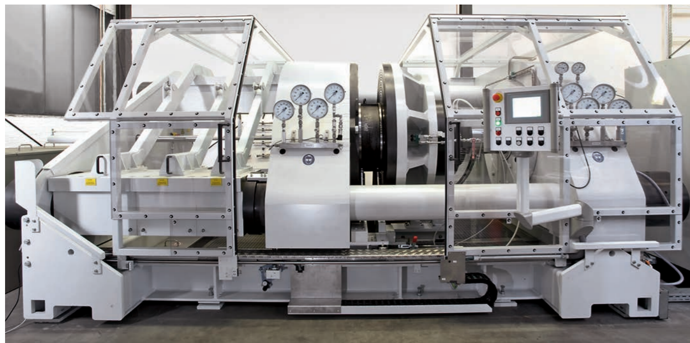
■ RITAG DN 1400 / 56" Prüfstand RITAG DN 1400 / 56" Test Facility
